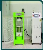
Beton Test Presi küp ve silindir beton numunelerine ait basınç dayanımı değerlerinin elde edilmesinde kullanılır.
