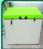
Betonun donma ve çözünme direncinin belirlenmesinde kullanılan Donma-Cözülme deneylerinde farklı sıcaklıklarda numunelerin boyları, ağırlıkları ve mekanik özellikleri ölçüerek donma çözülme tekrarları altında davranışları izlenir.
