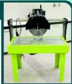
Bu deney, betondan alınan karot numunelerinde basınç dayanımı testini uygulamak amacıyla numunenin istenilen boyutlarında deneye hazırlaması amacıyla yapılır.
