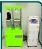
Otomatik çimento deney presleri, uygun aksesuarlar ile birlikte harç numunelerine ait basınç ve/veya eğilme deneylerinin yapılabilmesi amacıyla tasarlanmıştır.
