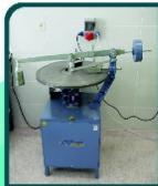
Böhme (Yatay) Aşındırma Cihazı, iç veya dış zemin kaplaması olarak kullanılan doğal taş ve beton ürünlerde, aşınma direncinin belirlenmesinde kullanılır.
